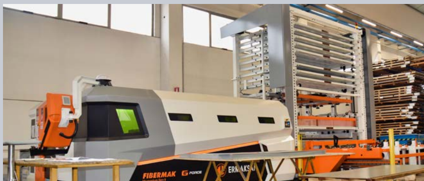
Vista dell'impianto di taglio laser a fibra Ermaksan Fibermak Momentum Gen-3, corredato di sistema di carico/scarico automatico Fibermak Towermak a 10 pallet totali
