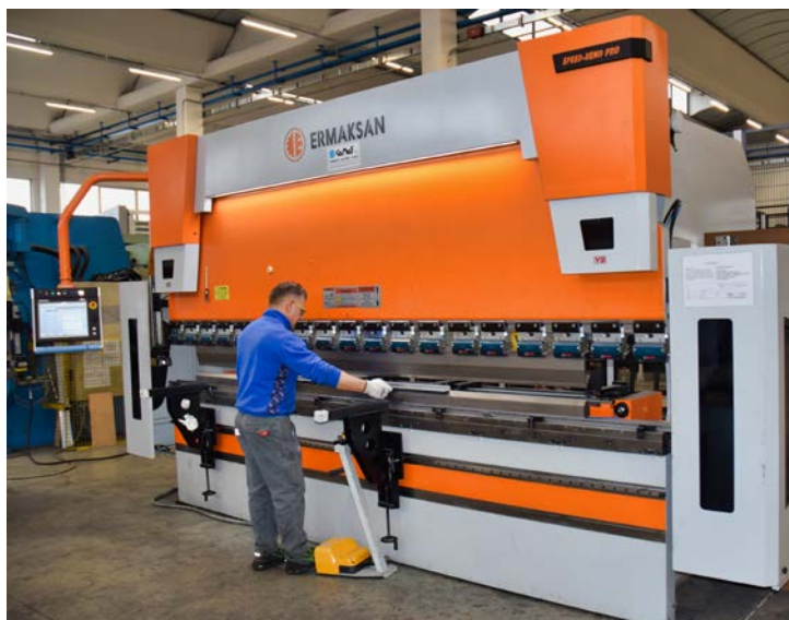
A garantire le fasi di piegatura con operatore in ODBMBM è anche la pressa piegatrice idraulica sincronizzata Ermaksan Speed-Bend a 6 assi da 220 ton per 4.100 mm di lunghezza utile di piega
