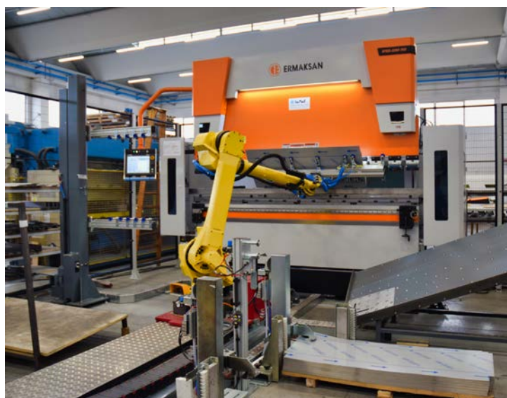
Dettaglio cella di piegatura robotizzata effettuata in ODBMBM con pressa piegatrice idraulica sincronizzata Ermaksan Speed-Bend a 6 assi da 175 ton per 3.100 mm di lunghezza utile di piega
