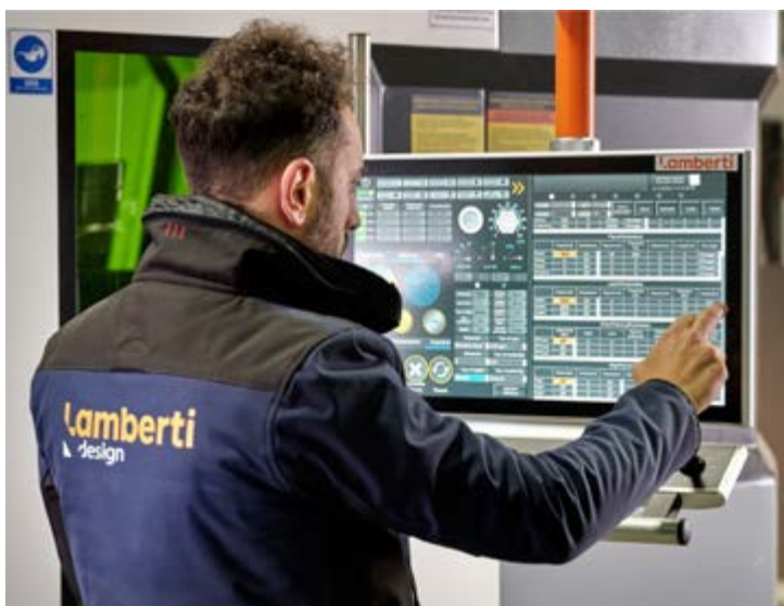
Dettaglio del Cnc Beckhoff CP6242, controllo che permette all'operatore di governare in modo semplice tutte le funzionalità dell'impianto di taglio laser a fibra Ermaksan Fibermak Momentum Gen-3 G Force
