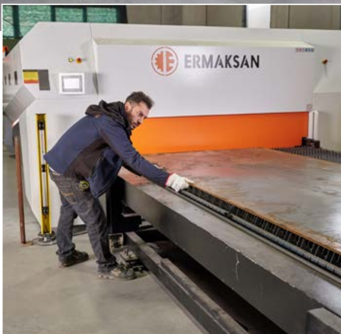
L'impianto di taglio laser a fibra Ermaksan Fibermak Momentum Gen-3 G Force consente a Lamberti Design di lavorare lastre di lamiera fino a 4.000 x 2.000 mm di dimensione massima
